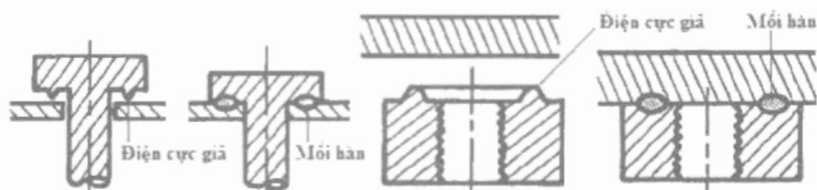
Hình 15.10. Một số sản phẩm hàn dùng điện cực giả dạng mẫu lõi
